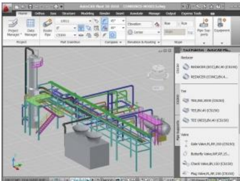
Рисунок 1. Рабочее пространство AutoCAD Plant 3D
