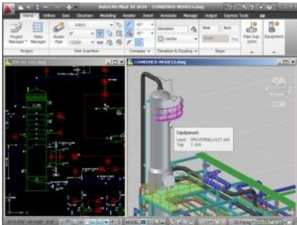
Рисунок 2. Интеграция AutoCAD Plant 3D с AutoCAD P&ID
